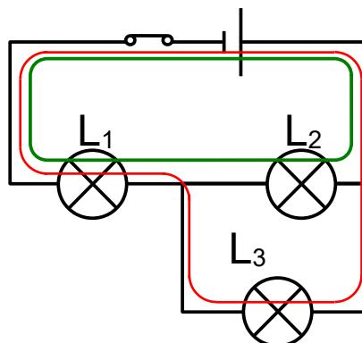
Rappel : On réalise un court-circuit quand on branche un simple fil aux bornes d'un dipôle ou d'un groupe de dipôles.
