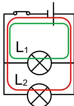
Les éléments d'un circuit électrique forment des boucles de courants passant par le générateur.
